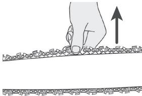
**ВНИМАНИЕ!** Регулярно проверяйте натяжение пильной цепи во время работы и корректируйте ее по необходимости. При натяжении цепь должна быть холодной! Натяжении нагретой цепи снижает ресурс ее использования.
