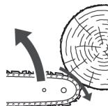
Будьте предельно внимательны и не подносите носок пильной шины до касания с предметом, это вызывает мгновенный обратный удар, при котором шина будет резко отброшена назад и вверх по направлению к оператору, в этом случае тормоз цепи автоматически активируется при достаточно сильной отдаче пилы – под действием инерции массы защиты руки. Защита руки перемещается вперёд к верхушке шины. Тормоз цепи работает только, если в конструкцию защиты руки не внесены изменения.
