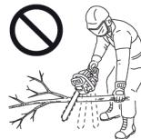
Допустимо работать этой моделью бензопилы, держа её в одной руке, только в случаях, когда оператор не имеет возможности дотянуться до места распила двумя руками. При этом он должен устойчиво разместиться, используя свободную руку, как опору.
