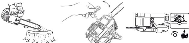
**ВНИМАНИЕ!** Регулировочный винт подачи масла поворачивается на 1/2 оборота, не прилагайте большое усилие во время регулировки, возможно повреждение масляного насоса. Данное повреждение не подлежит гарантии.
